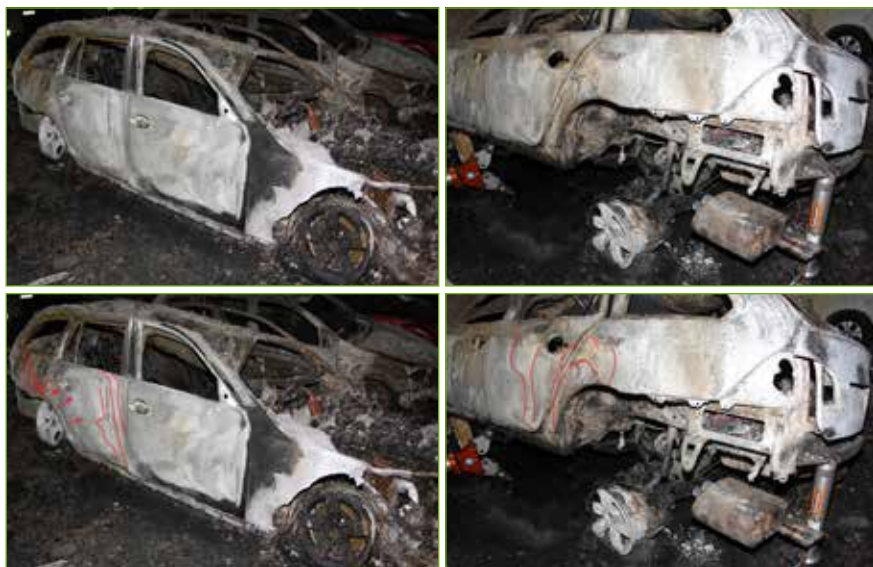
Jak je vidět, povrch karoserie postrádá ohraničené oblasti, které by ukazovaly na tepelné působení jehož zdroj se nacházel uvnitř vozidla.
