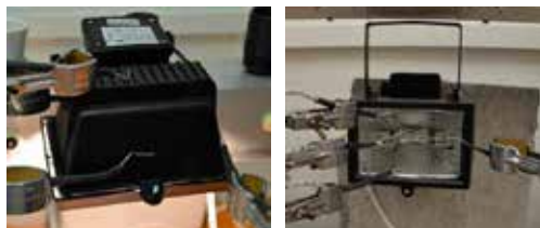
Svítlidlo MEROX Technics, IP 44, halogenová žárovka J78, 220-240V~, 120W, 50Hz, 2216 lm, energy C
