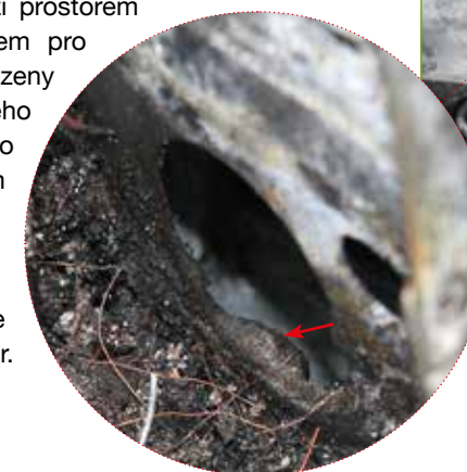
Ke zkratu došlo v místě průchodkou karoserie, kde došlo k odtavení části plechu karoserie (viz detail).
