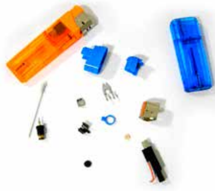
Obrázek 1: Části piezoelektrického zapalovače [8]
