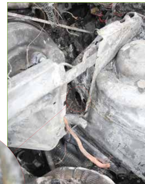
Ke zkratu došlo v místě průchodkou karoserie, kde došlo k odtavení části plechu karoserie (viz detail).
