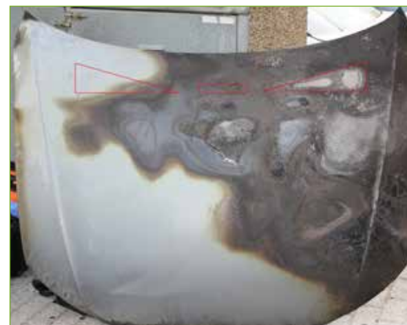
Zakreslení přední strany kapoty znázorňuje otvory v konstrukčním zpevnění kapoty z druhé strany (viz obr. vpravo nahoře).
